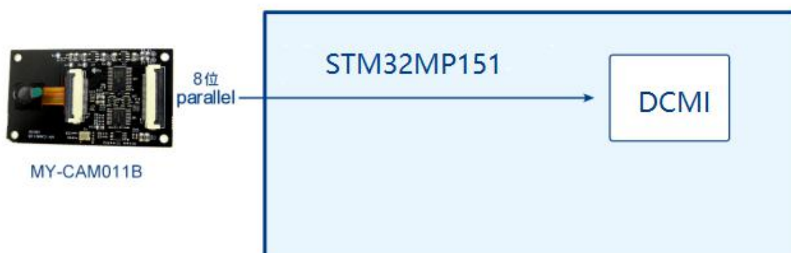
图 6-1 DCMI 接口接法
